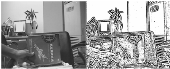
a 双目视觉系统中左摄像头获取的图像 b 高斯拉普拉斯滤波后图像
